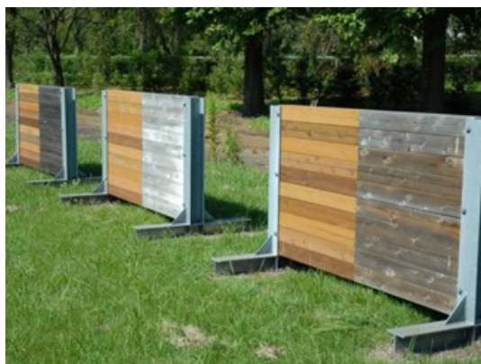
写真 3.7 保存処理木材への塗装例 （この例ではスギ遮音壁の試験体に塗装）
