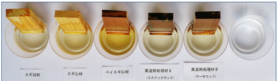
写真 3.4 水溶性着色物質の溶脱の様子（左から 3 番目がベイスギ）
