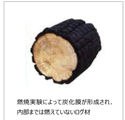
図 3.1 ログ材の炭化膜の形成
