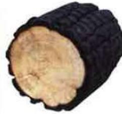
燃焼実験によって炭化膜が形成され、内部までは燃えていないログ材
