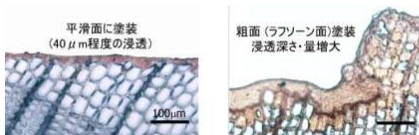
図 3.10 平滑面への塗装（左）とラフソーン仕上げ面への塗装（右）
