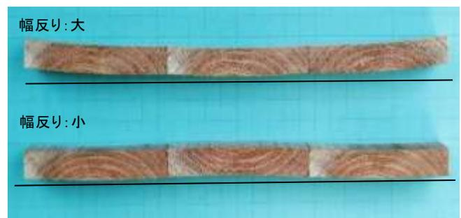
写真2 矧ぎ合わせ接着した板目板の収縮変形（木表・木裏の配置に注目）
