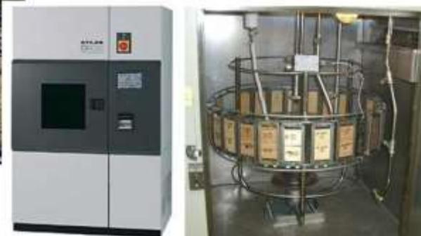
写真 3.6 塗装面の耐用年数の試験
